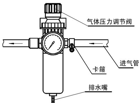
压缩空气必须符合第四项第 2 条规定，将气管与切割机后面板的空气过滤器进气嘴连接，用扎箍箍紧。调压过滤器的使用：调整压力时，先将气体压力调节阀旋钮往上拉起，然后旋转，左旋为减小出口气压，右旋为增大出口气压，压力调整后，压下调节阀旋钮定位。空气过滤器应定期检查排水，水位达到滤水杯的三分之二时，必须排水，否则影响切口质量。排水时关闭供气阀门，面板选择“试气”功能，当调压过滤器的气压表指示值为零时，水自动从排水嘴排出。
